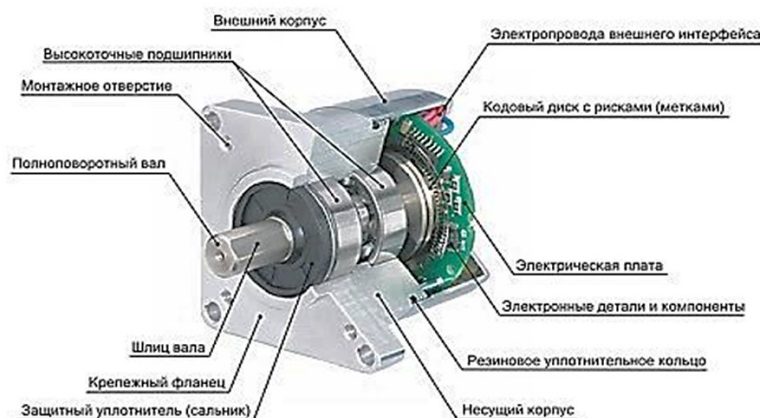
Рисунок 5.14 – Конструкция оптического энкодера*
