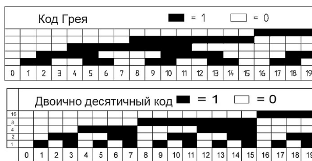
Рисунок 5.18 – Сравнение кодирующих масок с кодом Грея и двоично-десятичным кодом*
