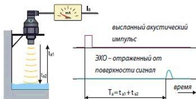
Рисунок 4.21 – Принцип действия ультразвукового измерения уровня локационным способом через воздушный слой
