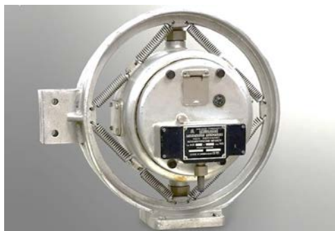
Рисунок 2.27 – Фотоэлектрический пирометр ФЭП-4 (СССР)*
