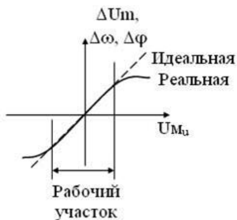
Рисунок 3.3 - модуляционная характеристика модулятора
