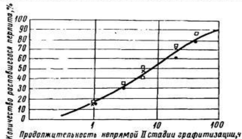
Рис. 147. Кинетика непрямой II стадии графитизации ковкого чугуна при 650° С, при разном количестве включений графита
