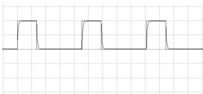
1.2-сурет – Ұзындығы 1 км сызықтағы сигнал осциллограммасы
