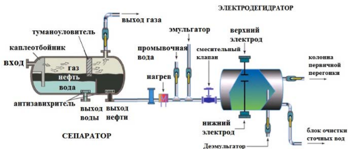
Рисунок 1.4 – Электрическое обезвоживание и обессоливание
