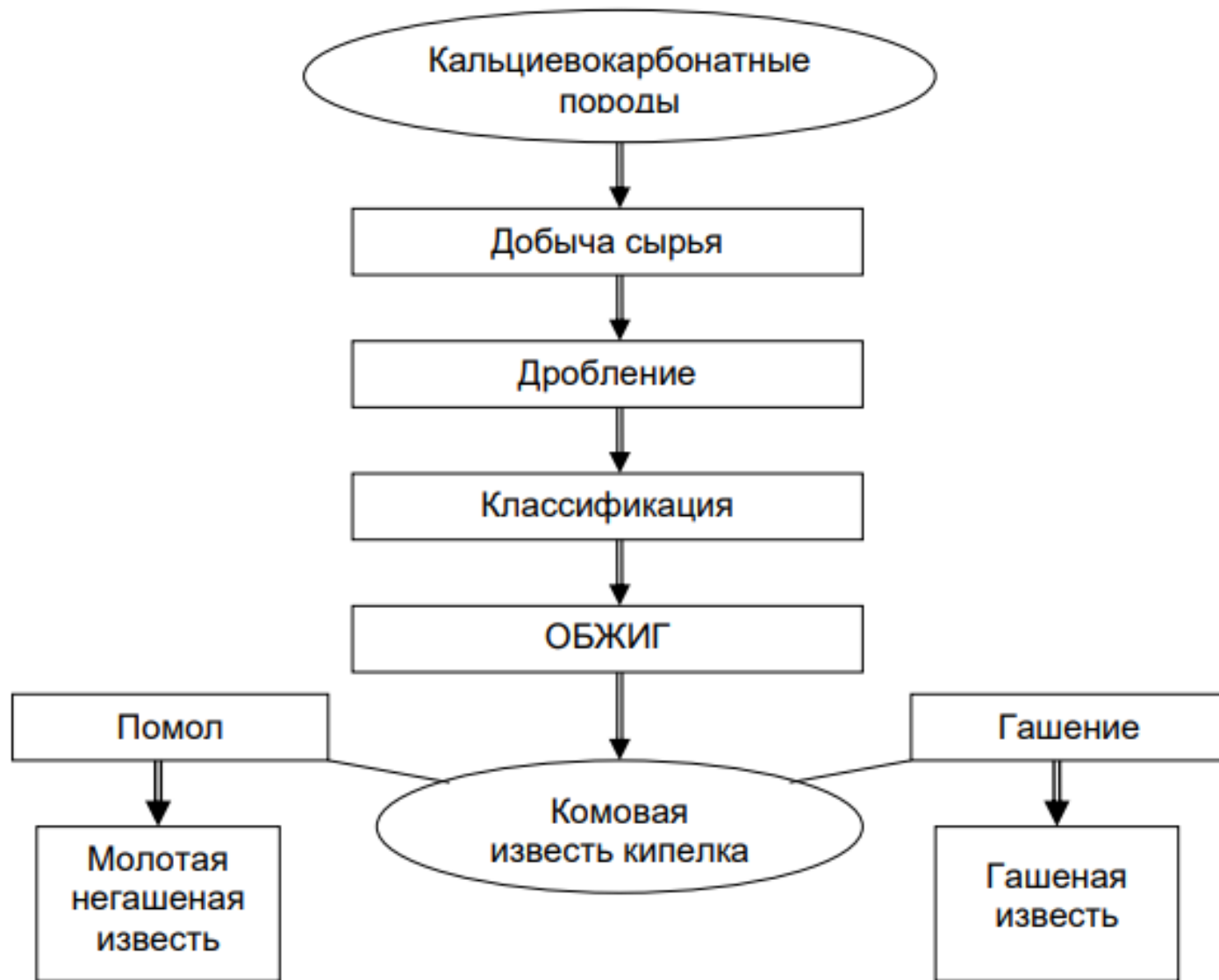
Рис. 8.2. Схема получения строительной извести
