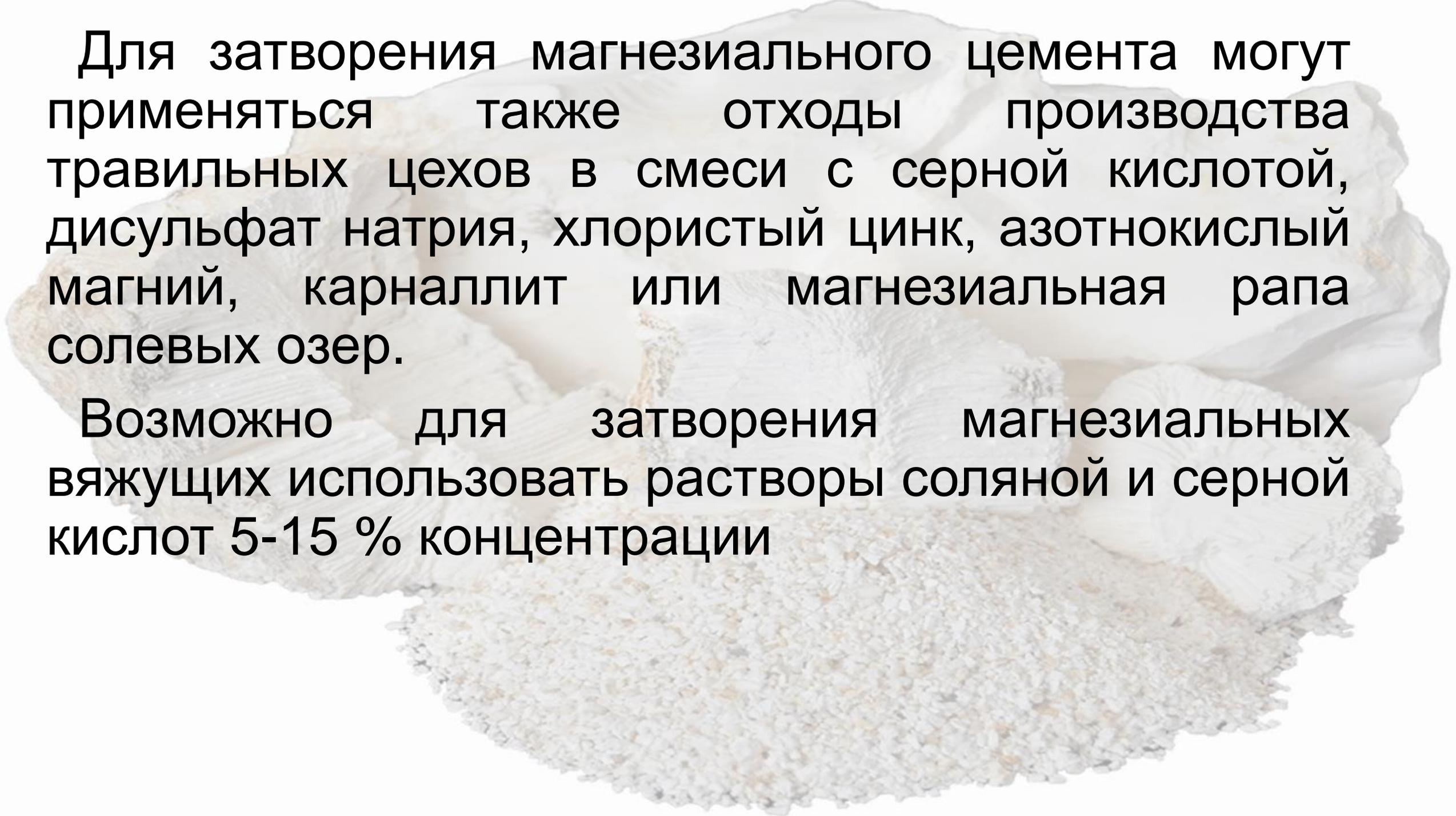
Для затворения магнезиального цемента могут применяться также отходы производства травильных цехов в смеси с серной кислотой, дисульфат натрия, хлористый цинк, азотнокислый магний, карналлит или магнезиальная рапа солевых озер.
