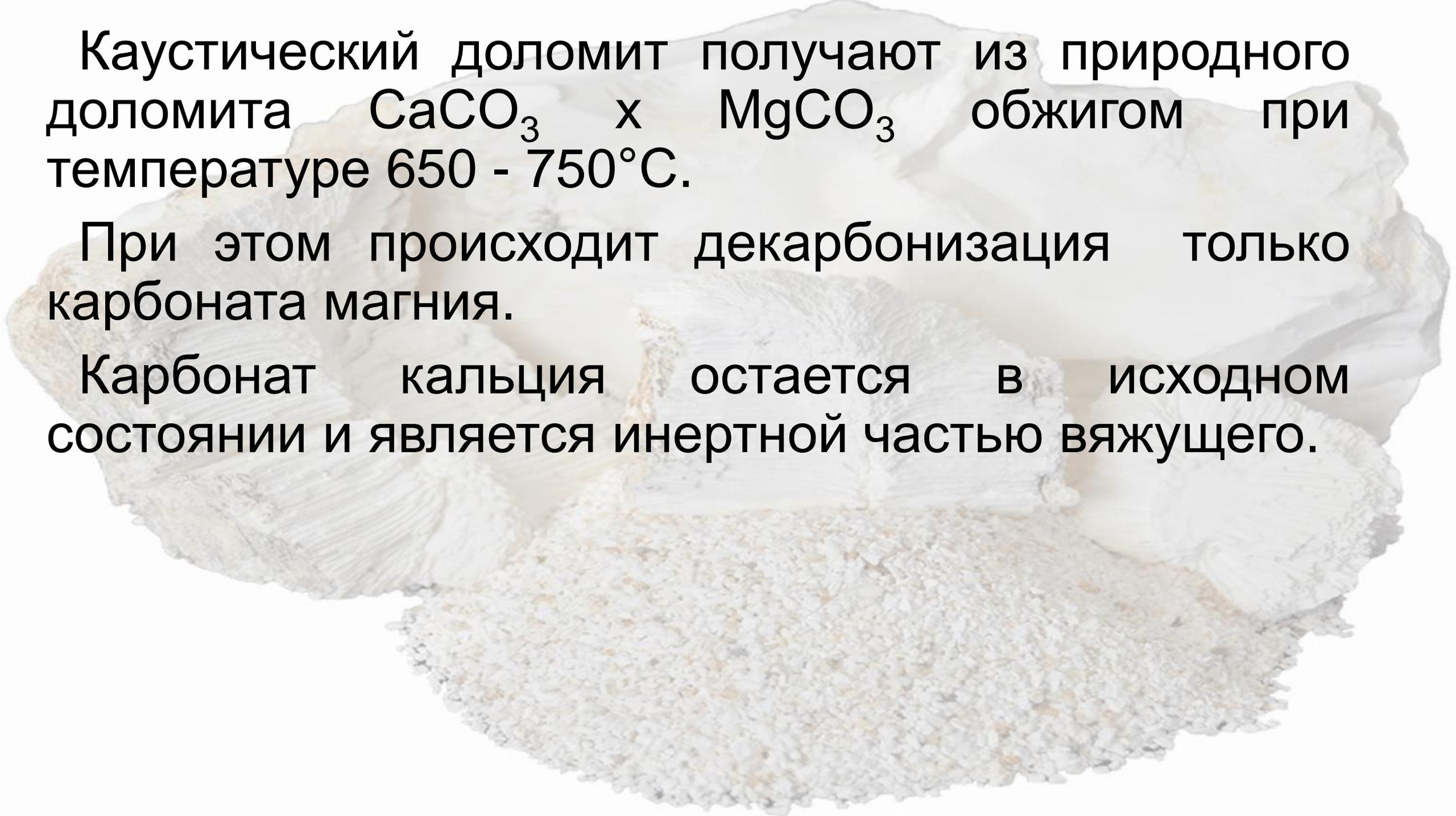
Каустический доломит получают из природного доломита  $\text{CaCO}_3$  х  $\text{MgCO}_3$  обжигом при температуре  $650 - 750^\circ\text{C}$ .
