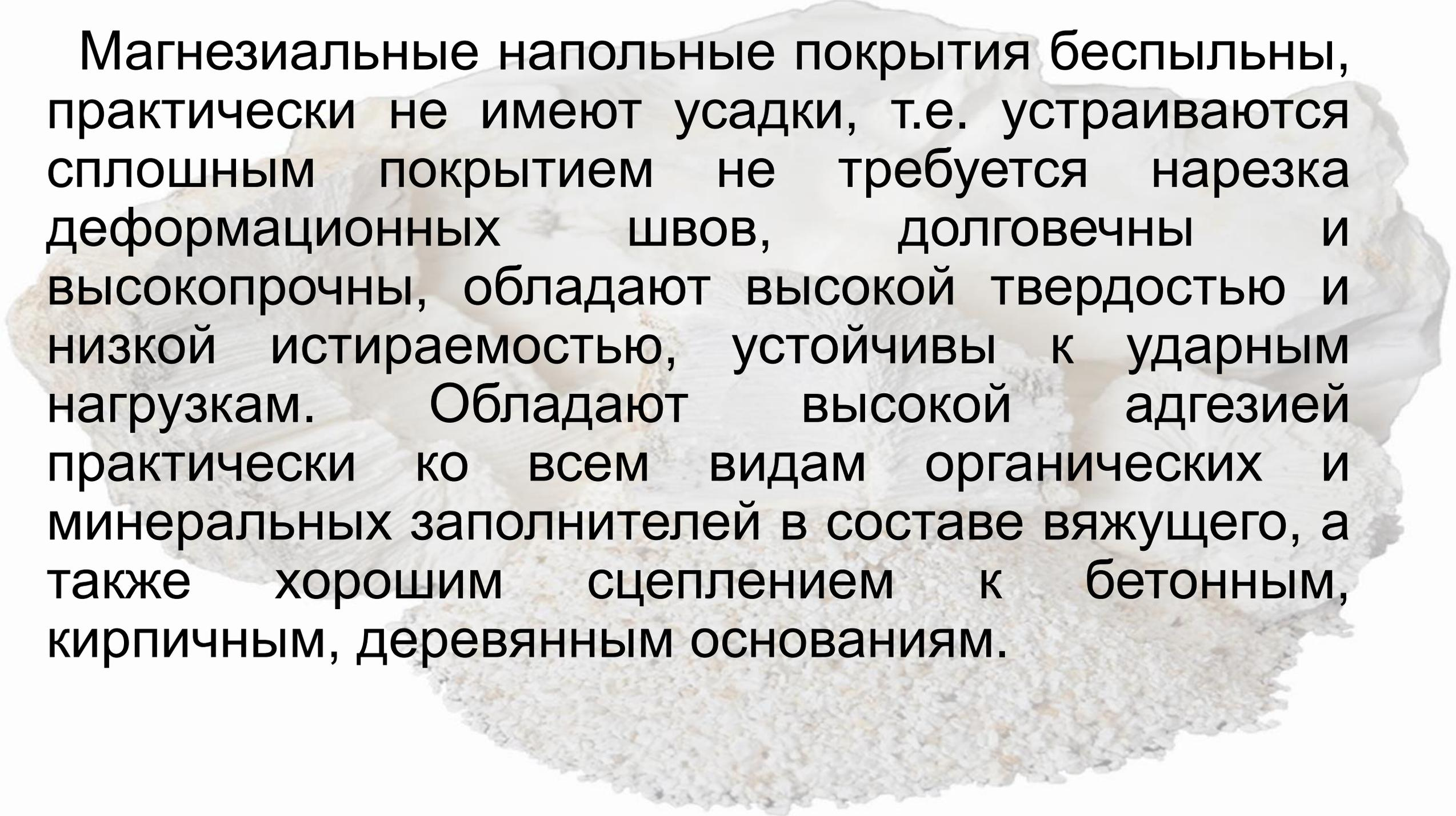
Магнезиальные наполненные покрытия беспыльны, практически не имеют усадки, т.е. устраиваются сплошным покрытием не требуется нарезка деформационных швов, долговечны и высокопрочны, обладают высокой твердостью и низкой истираемостью, устойчивы к ударным нагрузкам. Обладают высокой адгезией практически ко всем видам органических и минеральных заполнителей в составе вяжущего, а также хорошим сцеплением к бетонным, кирпичным, деревянным основаниям.
