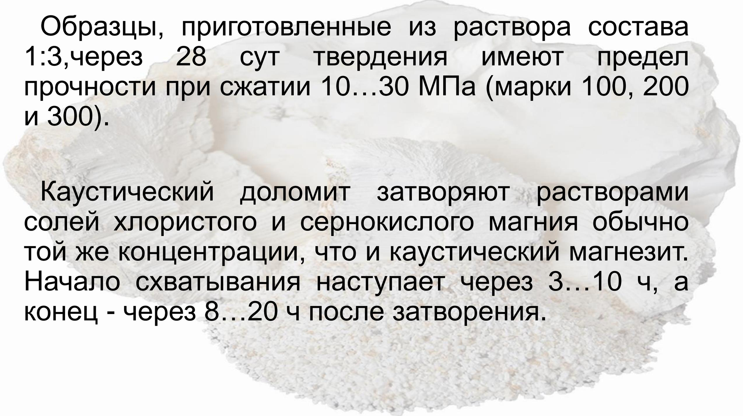
Образцы, приготовленные из раствора состава 1:3, через 28 сут твердения имеют предел прочности при сжатии 10...30 МПа (марки 100, 200 и 300).
