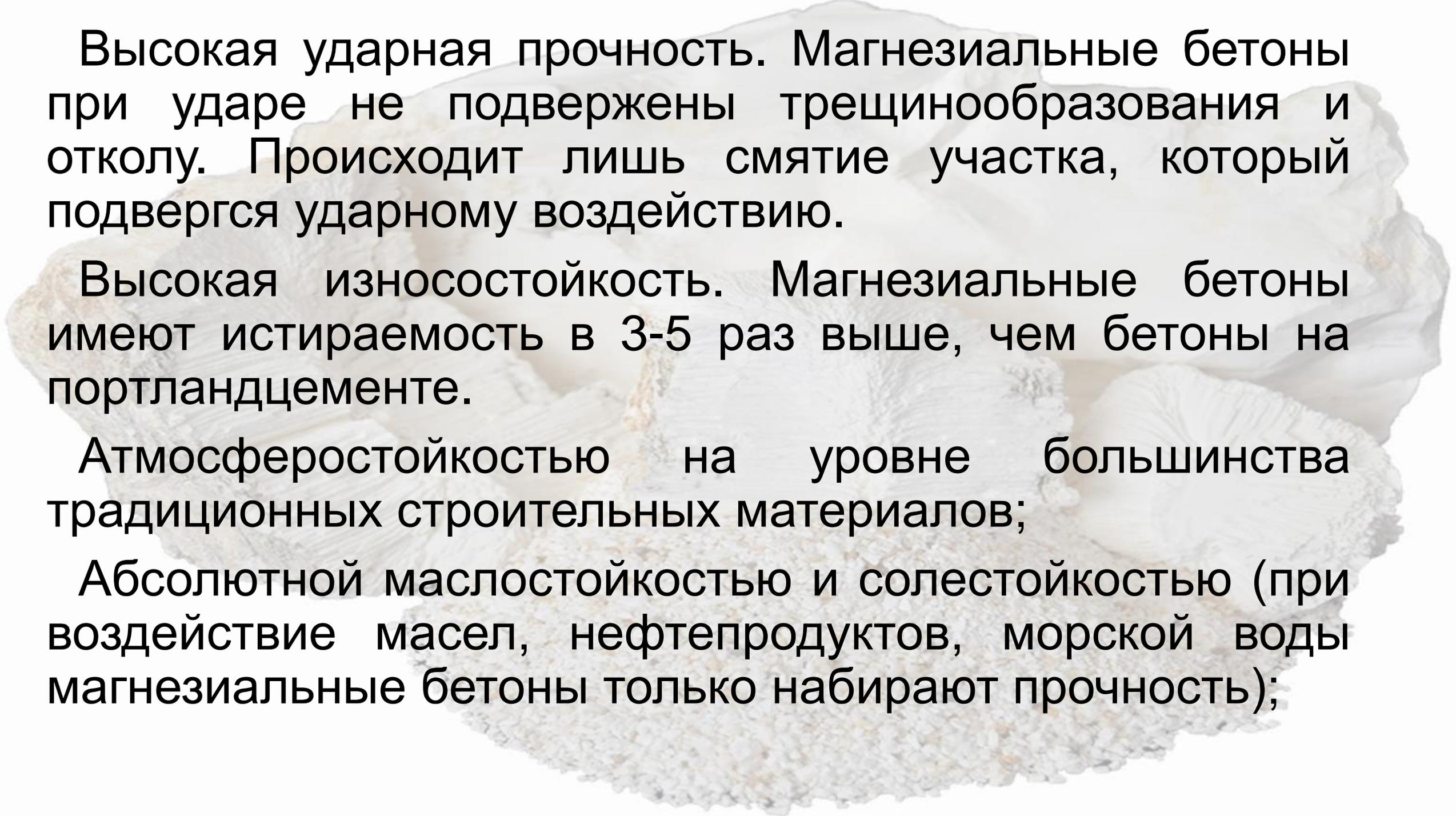
Высокая ударная прочность. Магнезиальные бетоны при ударе не подвержены трещинообразованию и отколу. Происходит лишь смятие участка, который подвергся ударному воздействию.
