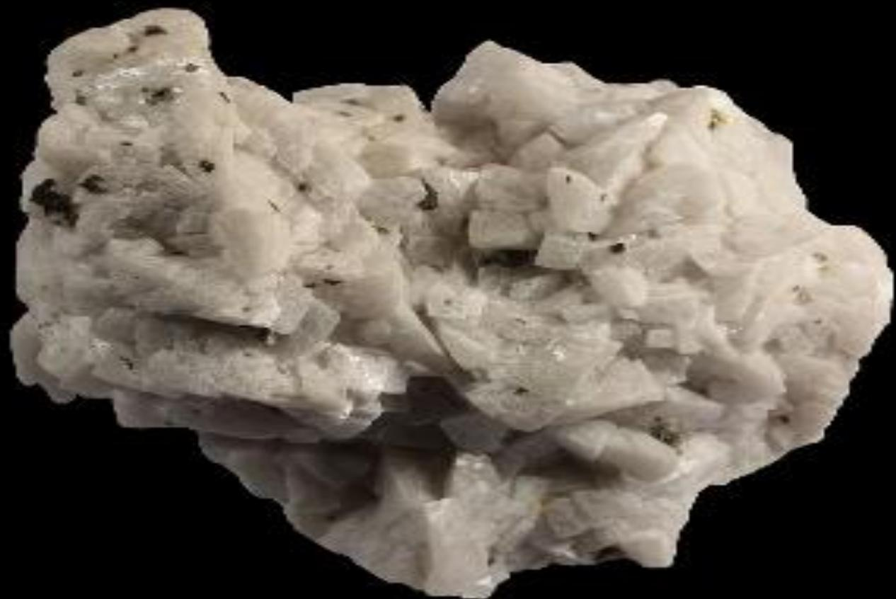
Твердость доломита по шкале Мооса 3,5-4,0; уд. вес 2,85-2,95. Теоретическое содержание в доломите  $\text{CaCO}_3$ -54,27%;  $\text{MgCO}_3$ -45,73% или в окислах:  $\text{CaO}$ -30,41%;  $\text{MgO}$ -21,87% и  $\text{CO}_2$ -47,72%.
