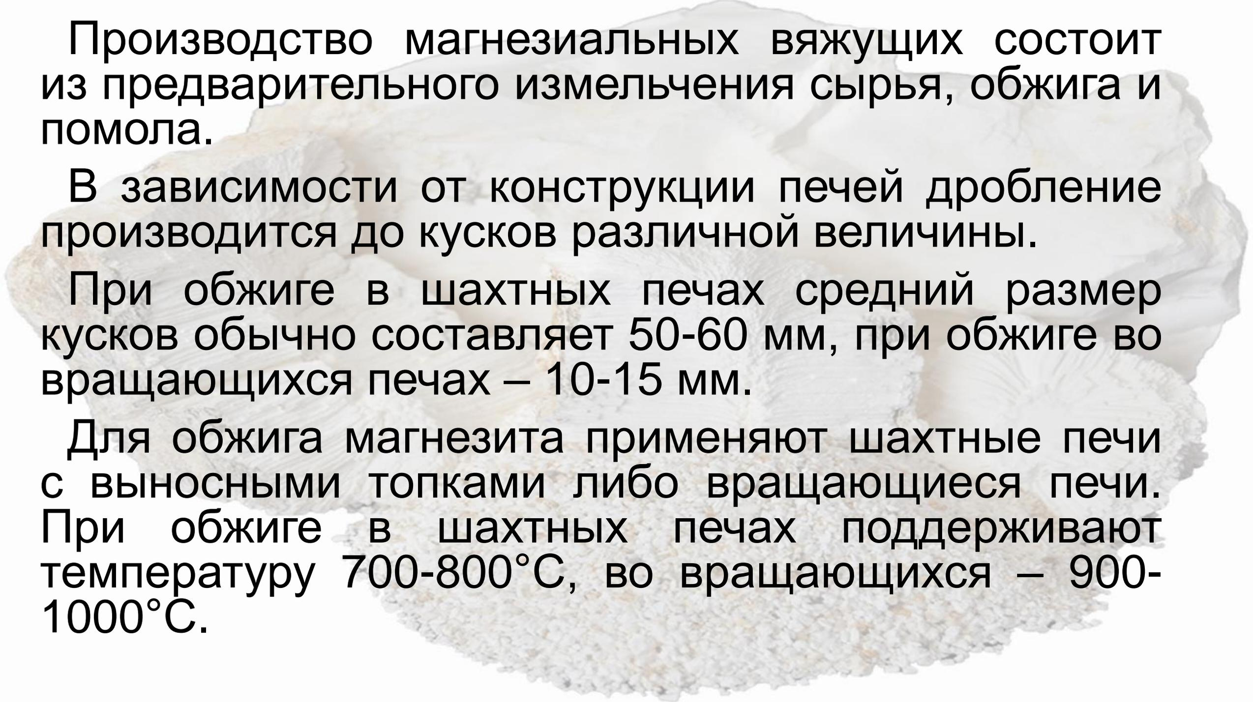
Производство магнезиальных вяжущих состоит из предварительного измельчения сырья, обжига и помола.
