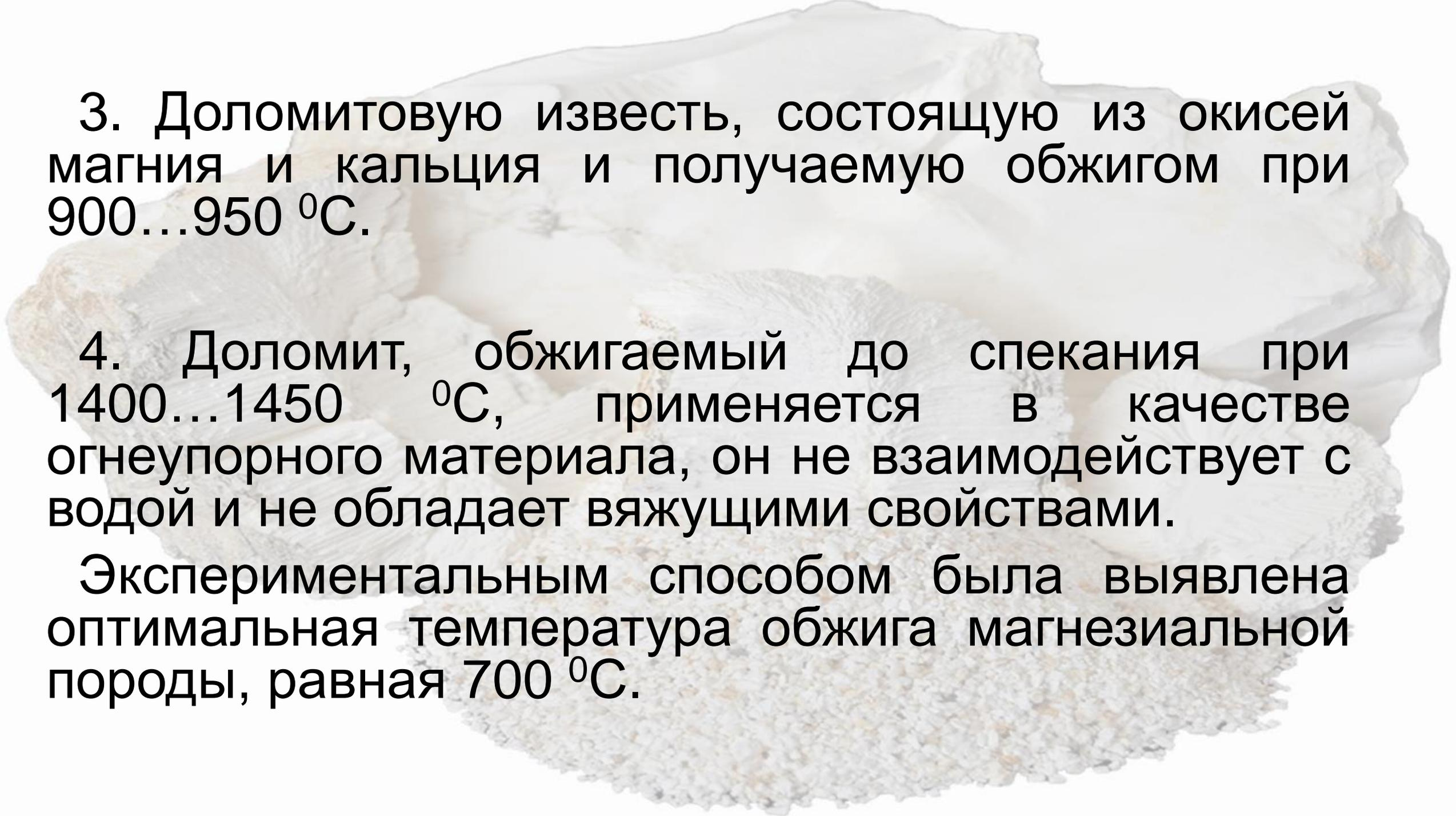
3. Доломитовую известь, состоящую из окисей магния и кальция и получаемую обжигом при 900...950 °С.
