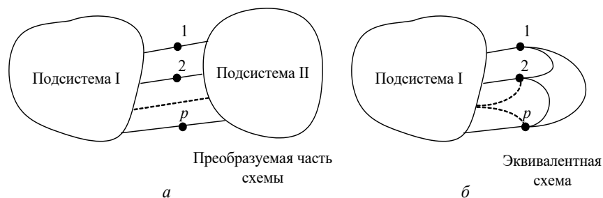
Рис. 3.12. Условное изображение ЭЭС с эквивалентруемой частью:
