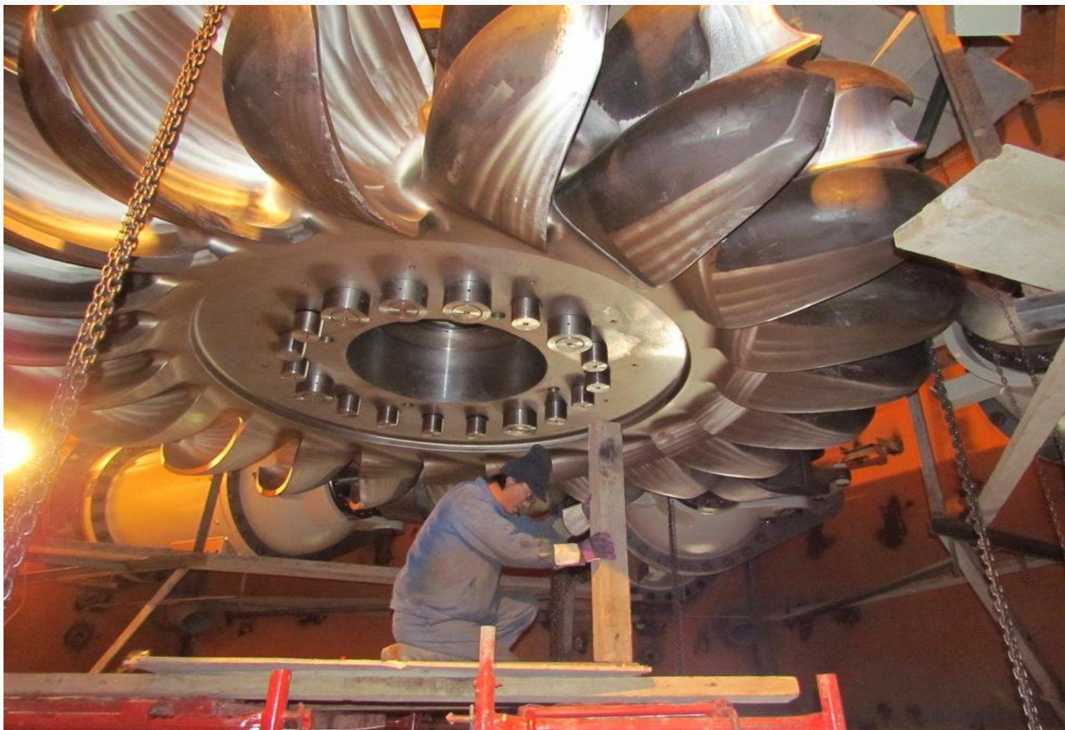
Ковшовое рабочее колесо для гидротурбины Мойнакской ГЭС
