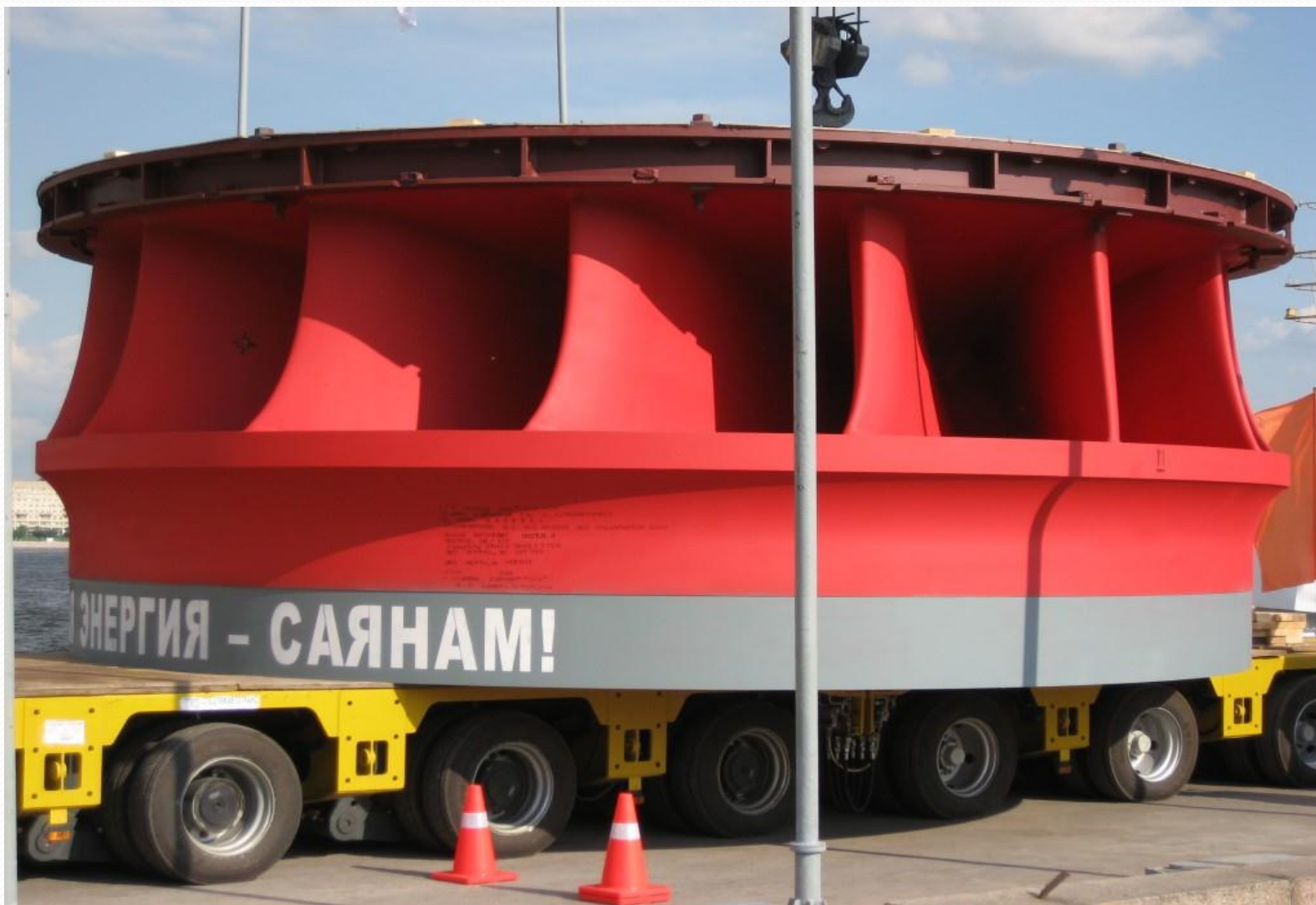
Радиально-осевое рабочее колесо для гидротурбины Саяно-Шушенской ГЭС
