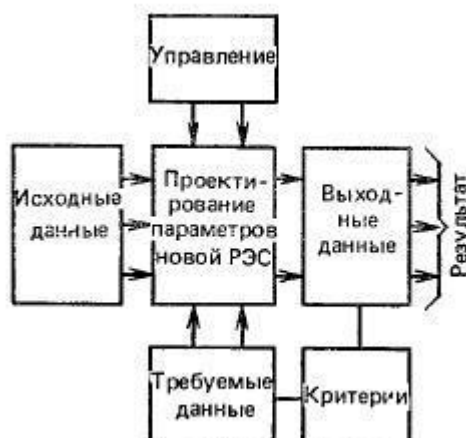
Рисунок 1.2 - Структура процесса создания РЭС
