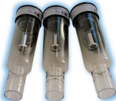
Рисунок 6 – Лампа с полым катодом
