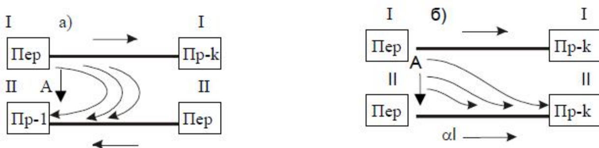
а) на ближнем конце; б) на дальнем конце Рисунок 4.5 – Возникновение переходных помех:
