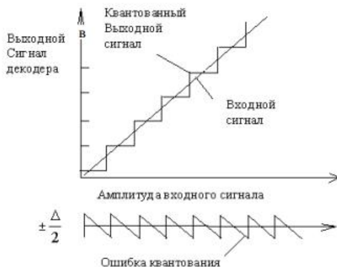
Рисунок 3.22– Зависимость ошибок квантования от амплитуды отсчета
