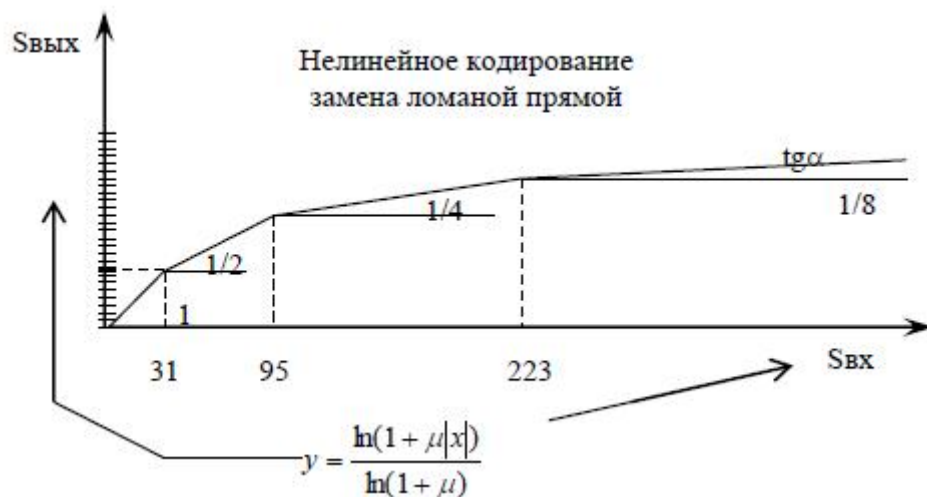
Рисунок 2.4 – Аппроксимация при неравномерном квантовании
