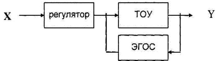
**Комбинированное управление**, при котором система с обратной связью сочетается с компенсатором. При оптимальном выборе характеристик система может обеспечить предельно возможные значения критериев эффективности, однако при этом требуются математические модели всех входящих в процесс операций и исчерпывающие сведения о возмущающих воздействиях.
