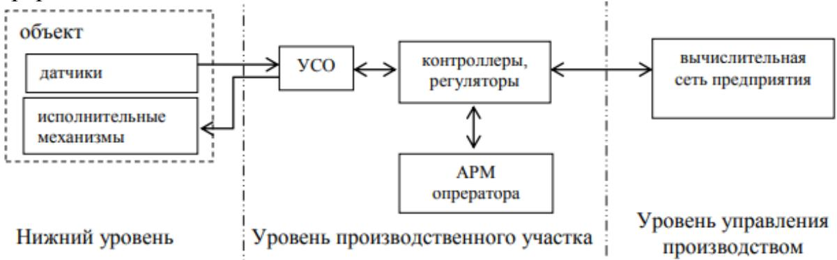
Самым нижним уровнем является уровень датчиков и исполнительных механизмов, которые устанавливаются непосредственно на технологических объектах. Их деятельность заключается в получении параметров процесса, преобразовании их в соответствующий вид для дальнейшей передачи на более высокую ступень (функции датчиков), а также в приеме управляющих сигналов и в выполнении соответствующих действий (функции исполнительных механизмов).
