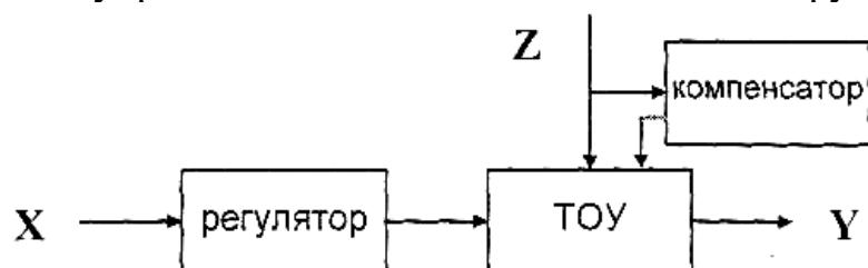
**Управление с обратной связью**, при котором автоматически контролируется фактическое состояние регулируемых параметров и формируется управляющее воздействие, которое обеспечивает нормальное течение управляемого процесса без анализа возмущающих воздействий
