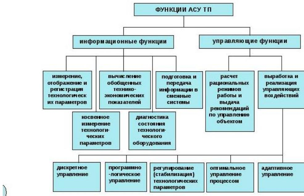
**Управляющая функция АСУТП** – это функция, результатом которой являются выработка и реализация управляющих воздействий на технологический объект управления, включающий в себя: переработку, хранение и выработку управляющей информации, передаваемой в виде управляющего воздействия технологическому объекту управления по каналам связи..
