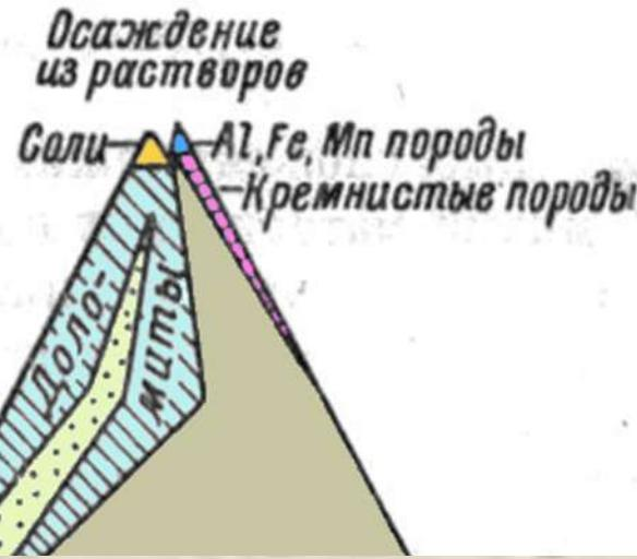
Площади, занятые в треугольнике, примерно пропорциональны частоте нахождения соответствующих пород в осадочной оболочке.
