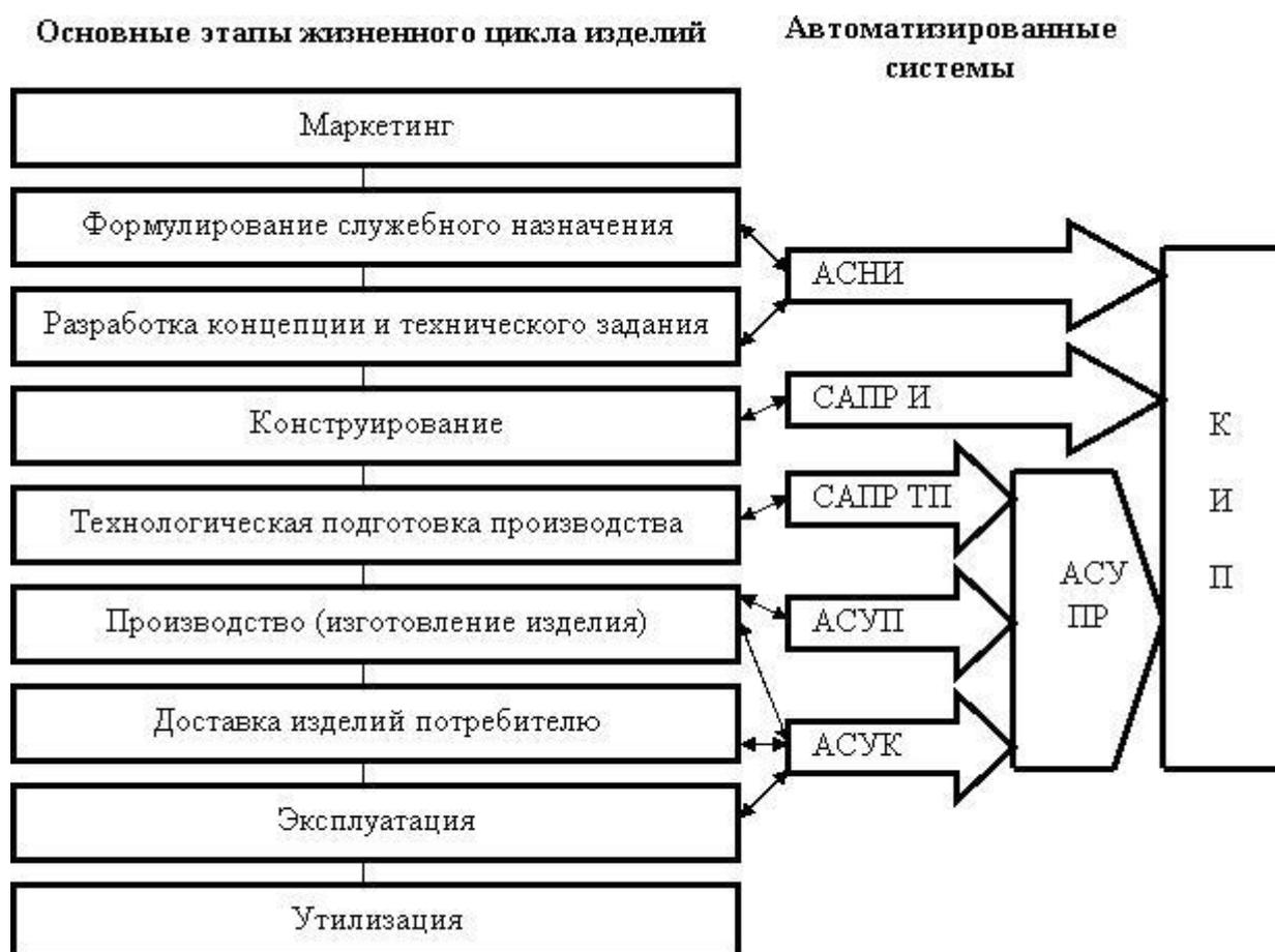
Рисунок 16 - Основные системы компьютерно-интегрированного производства
