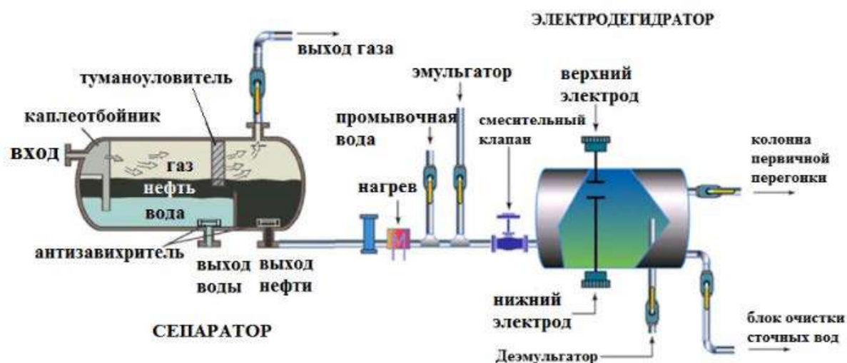
Рисунок 1.4 – Электрическое обезвоживание и обессоливание
