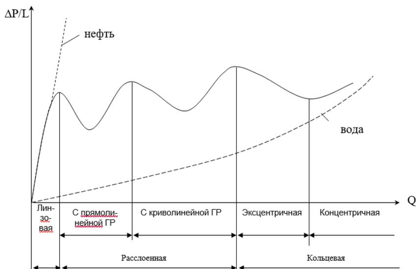
Рисунок 1.3 – Зависимость гидравлического уклона от расхода при перекачке смеси нефти и воды
