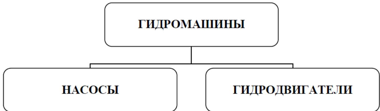
Рисунок 12.1 – Классификация гидромашин
