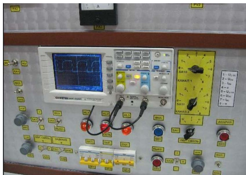
Рисунок 3.5 – Управляющее устройство электропривода
