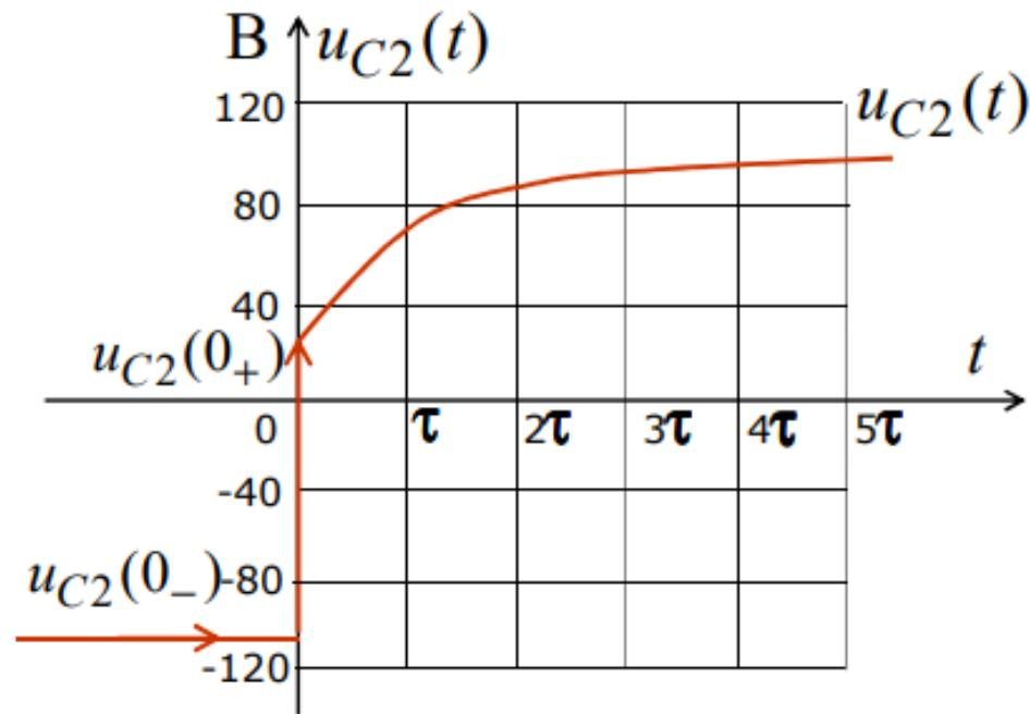
Переходной процесс напряжения на конденсаторе  $u_{C2}(t)$  во времени  $t$ , после коммутации в электрической цепи
