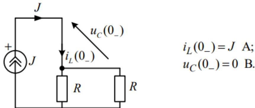
2. Для схемы после коммутации составляем уравнения по законам Кирхгофа. Система дифференциальных уравнений первого порядка должна быть разрешена относительно производных для получения уравнений. Для получения уравнений можно воспользоваться **методом наложения**.
