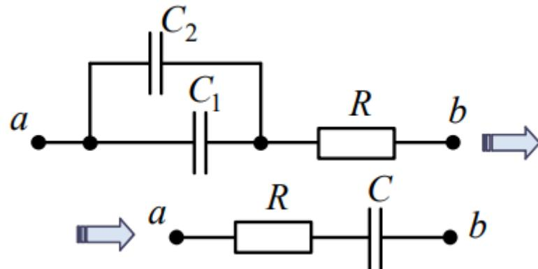
$$\text{здесь } R = R_1 + R_2; \quad C = C_1 + C_2.$$
