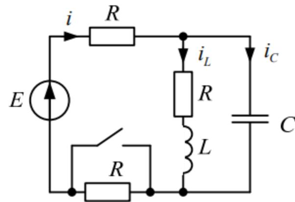
Определяем независимые начальные условия (**ННУ**) в схеме [до коммутации](#). Так как при постоянном источнике конденсатор представляет собой разрыв, а катушка становится закороткой, то
