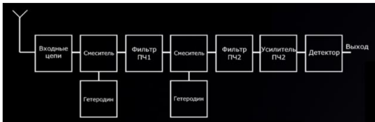
Типичная схема супергетеродина.
