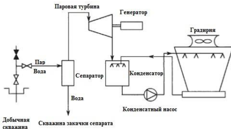
Рис. ?. Принципиальная схема работы ГеоЭС
