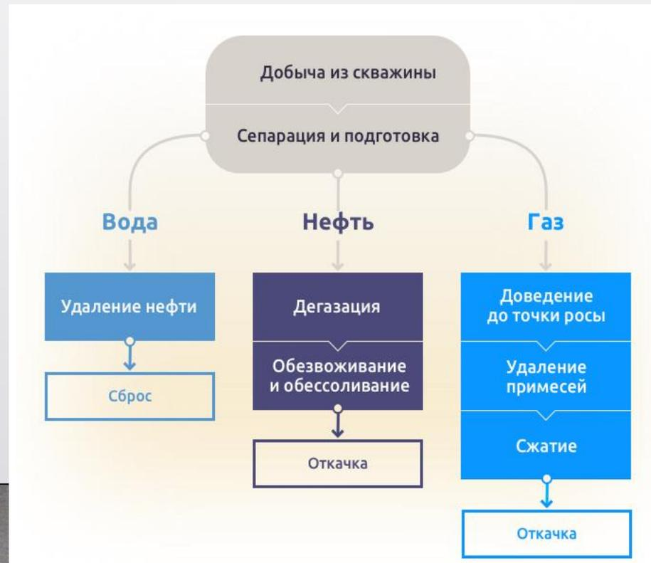
Для проведения сепарации используются специальные устройства, различающиеся принципом действия, например, они могут быть центробежными или гравитационными.
