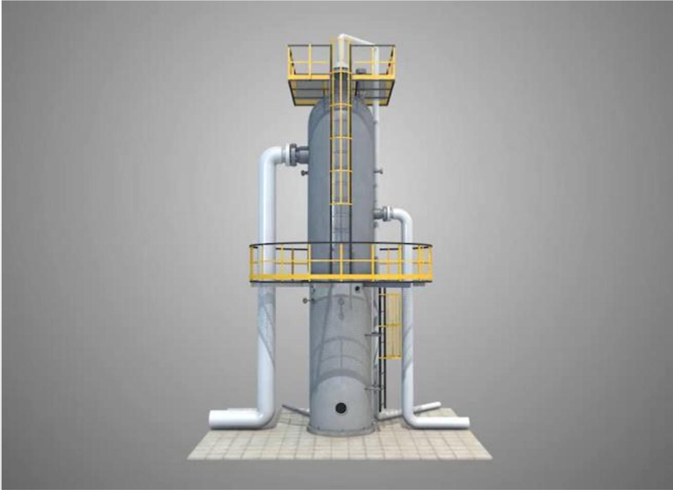
Термическое обезвоживание нефти. Одним из основных современных приемов обезвоживания нефти является термическая, или тепловая, обработка, которая заключается в том, что нефть перед отстаиванием нагревают. Вязкость вещества бронирующего слоя на поверхности частицы воды при повышении температуры уменьшается и прочность оболочки снижается, что облегчает слияние глобул воды. Кроме того, снижение вязкости нефти при нагреве увеличивает скорость оседания частиц при отстаивании.
