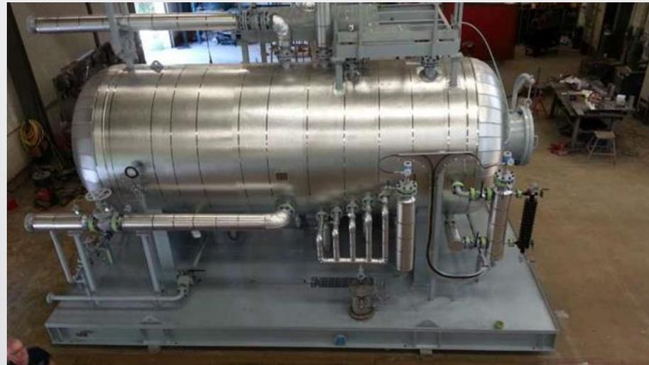
Выбор температуры определяется свойствами сырой нефти: для маловязких легких во избежании кипения самой нефти применяют более низкие температуры, а для тяжелых углеводородов - более высокие. Оптимальной температурой обессоливания следует считать от 100 до 120 °С. Температуры от 120 °С до 140 °С - для тяжелых, вязких углеводородов.
