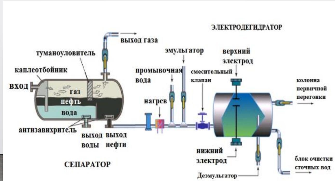
Возможность применения электрического способа в сочетании с другими способами (термическим, химическим) можно отнести к одному из основных его достоинств. Правильно выбранные режимы электрической обработки практически позволяют успешно провести обезвоживание и обессоливание любых эмульсий.
