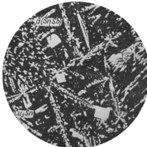
Микроструктура баббита Б88 . \times 100
